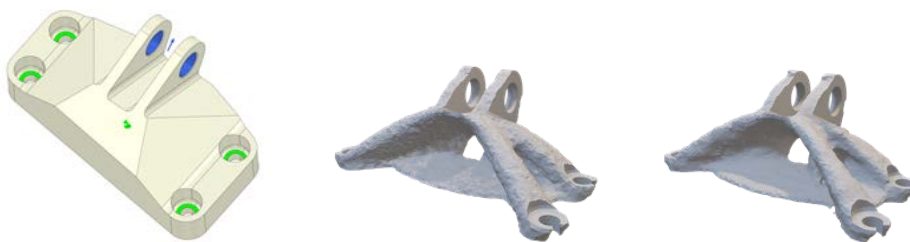
Abbildung 1: Designraum der GE Bracket Challenge und Ergebnisse der Topologieoptimierung der kommerziellen Software und Eigenentwicklung (5% Steifigkeitsunterschied)
