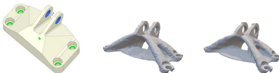
Obrázek 1: Návrhový prostor soutěže GE Bracket Challenge a výsledky optimalizace topologie provedené komerčním softwarem a vlastním vývojem (5% rozdíl v tuhosti)
