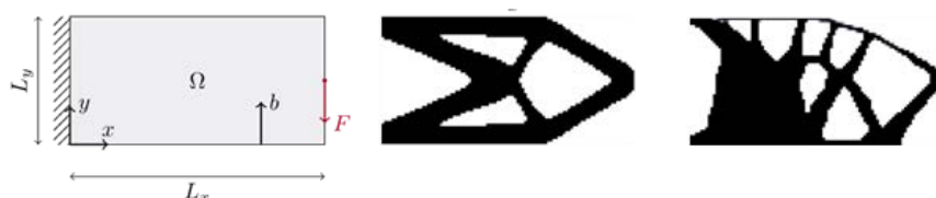
Obrázek 2: Návrhový prostor pro 2D nosníkový problém a výsledky volné topologické optimalizace a nové metody pro aditivní výrobu
