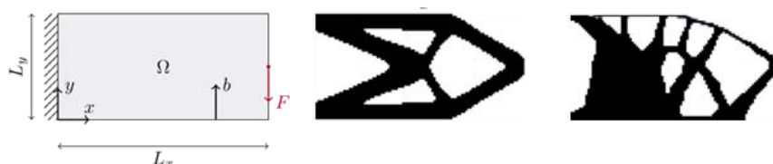
Abbildung 2: Designraum eines 2D Balkenproblems und Ergebnisse der freien Topologieoptimierung und der neuartigen Methode für die additive Fertigung
